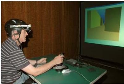
Bild 1: Versuchsaufbau mit Retinal Display und Sichtsimulation
