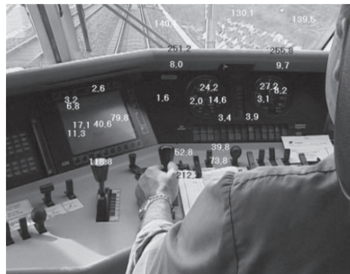
Bild 4: Leuchtdichten (Kalifeinheiten) im ICE-Führerstand
